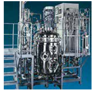
【図2】ものづくりセンター内に設置する光合成細菌の培養槽
