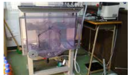
【図3】福島県内の実地プラントに設置する廃水処理槽の試作品。中のかごにビーズを入れる
