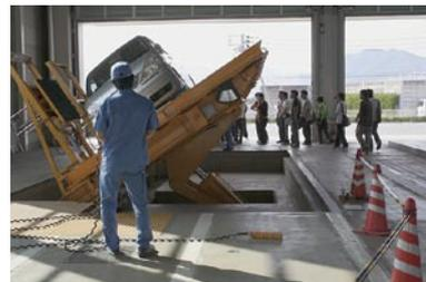
傾斜角度測定機による検査
