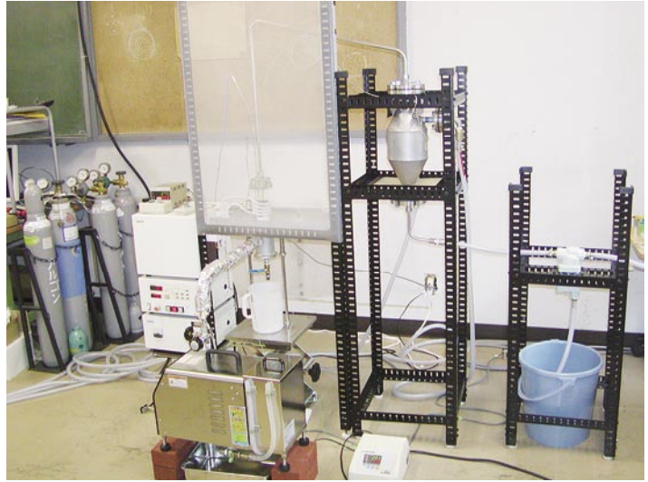
過熱水蒸気式リサイクルシステム
